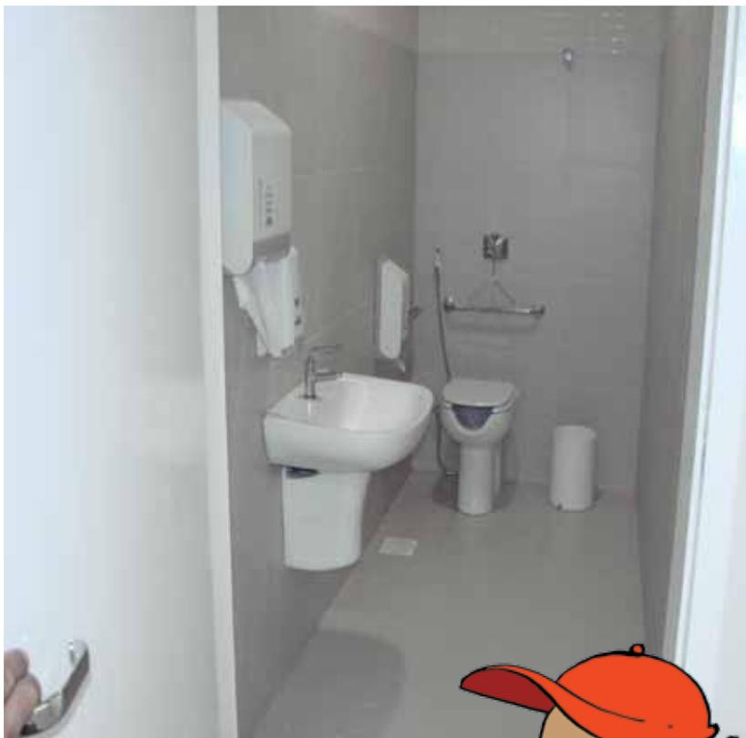
*Um sanitário com acessibilidade deve ter porta de acesso com 80 cm de largura útil, no mínimo. A bacia incluindo assento deve ter altura máxima de 46 cm do piso, barras de apoio medindo de 3 cm a 4 cm de diâmetro a uma altura do piso de, no máximo, 77 cm.*
